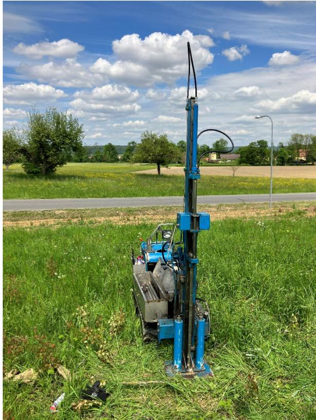
**Bild 21: Aufgestelltes Rammsondiergerät**
